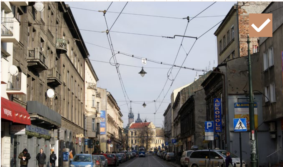
28 Vhodný príklad použitia závesnej osvetľovacej sústavy v užšom profile ulice, kde by použitie štandardných stožiarov mohlo zbytočne zužovať šírku chodníkov. Krakow, Poľsko
