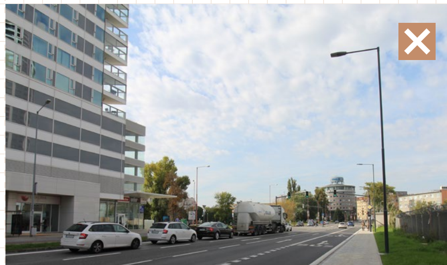
21 Nevhodný príklad, kde v prípade výmeny VO na jednej strane ulice nebolo vymenené aj osvetlenie na opačnej strane. Dôsledkom je nejednotný vzhľad ulice z dôvodu rozdielného dizajnu a farby svietidiel. Bratislava, Landererova
